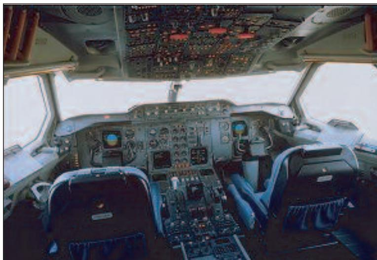
*Figure 5 : Cockpit A 310 à 6 visualisations CRT 5"x5"*
