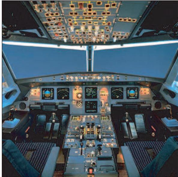
Figure 6 : Cockpit A 320 à visualisations CRT 6''x6''
