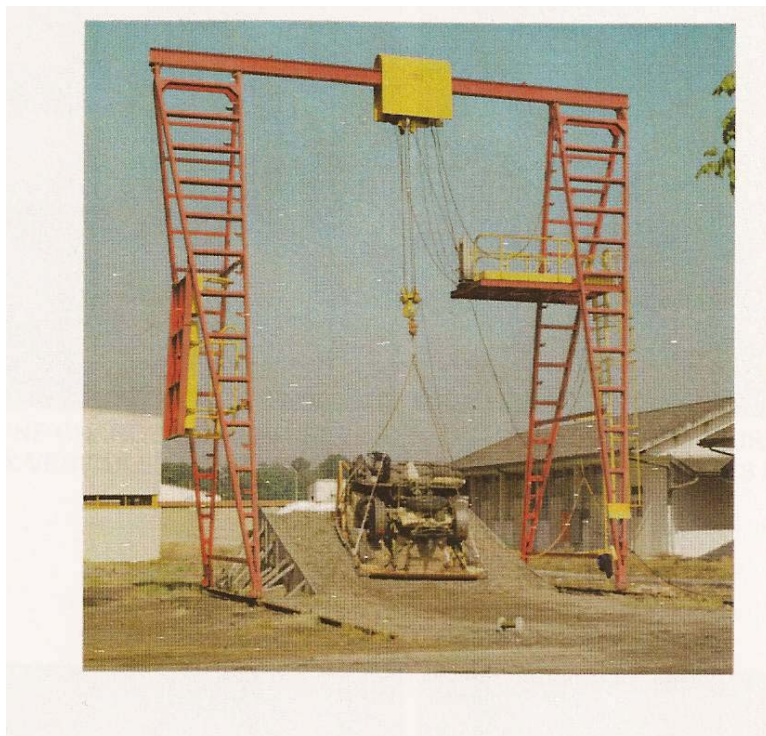
Fig. 3 Portique d'essais de chutes permettant de vérifier l'aptitude des matériels au largage
