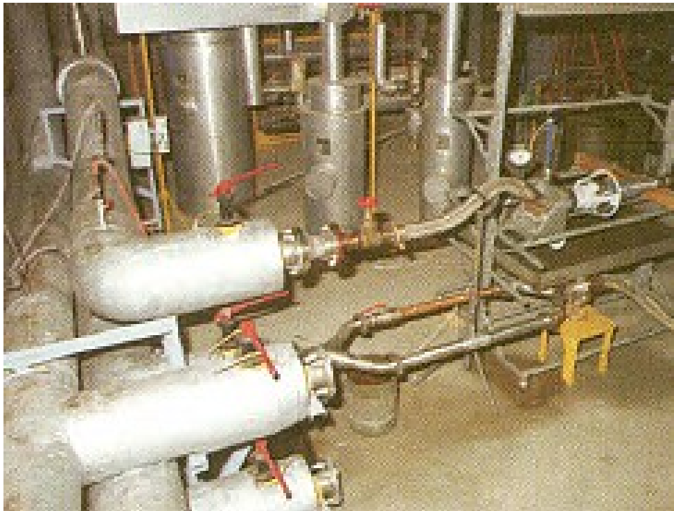
Fig. 24 Essai de givrage de système de ravitaillement en vol
