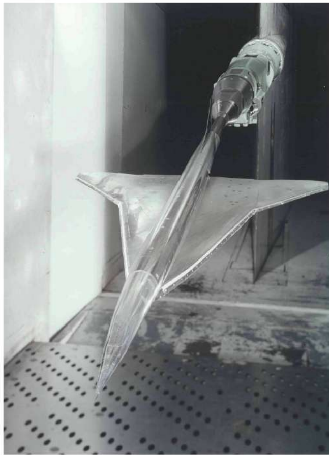
Fig. 54 Essai d'une maquette d'ATSF (Avion de transport supersonique futur) dans la soufflerie S2MA de Modane
