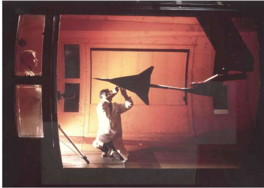
Fig. 53 Essai d'une maquette d'ATSF (Avion de transport supersonique futur) dans la soufflerie S2Ch de Meudon
