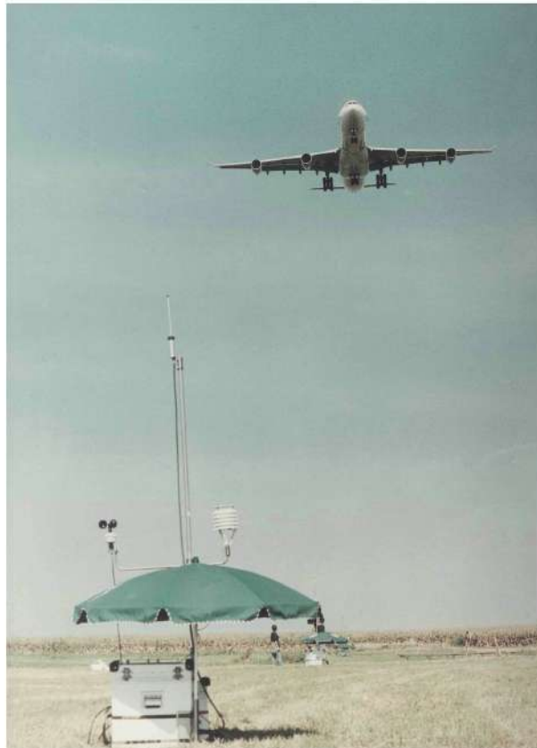
Fig. 21 Survol à faible altitude d'un Airbus A340, pour la localisation des sources acoustiques. Essais effectués avec l'Aérospatiale à Tarbes en 1997
