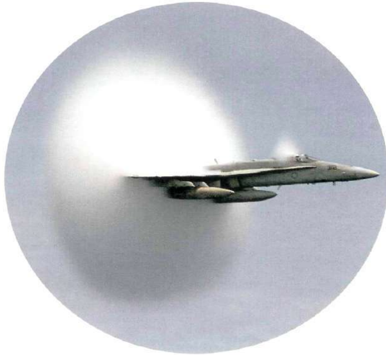
Fig. 3 « Matérialisation » des poches supersoniques par condensation de la vapeur d'eau atmosphérique autour d'un F/A-18 Hornet à l'approche de Mach 1 (année 2000)
