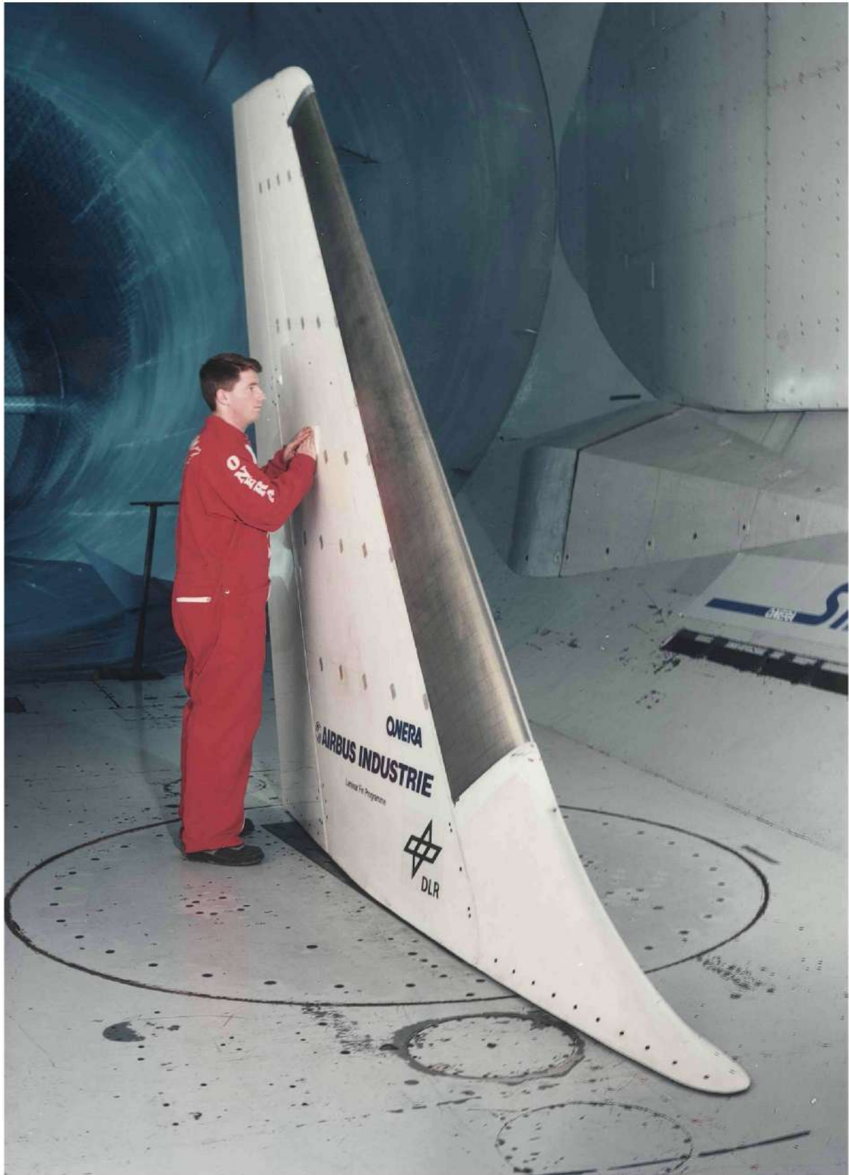
Fig. 42 Essai de laminarité sur une dérive d'A320 dans la soufflerie S1MA de Modane en coopération ONERA-DLR
