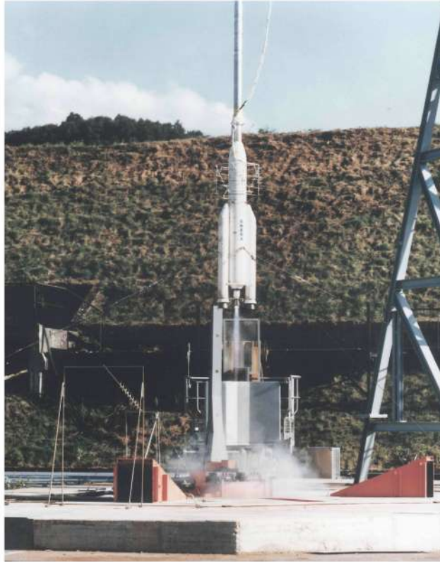
Fig. 108 Étude d'aéroacoustique au Fauga sur une maquette d'Ariane
