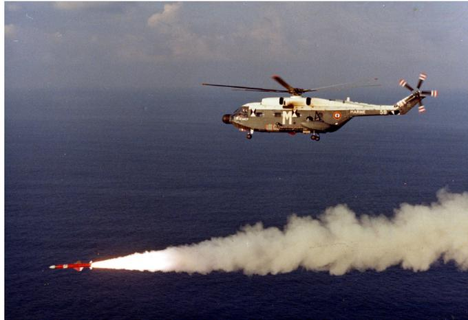
Figure 54 - Tir d'un missile AM 39 depuis un SA 321 G au CEV, à Cazau
