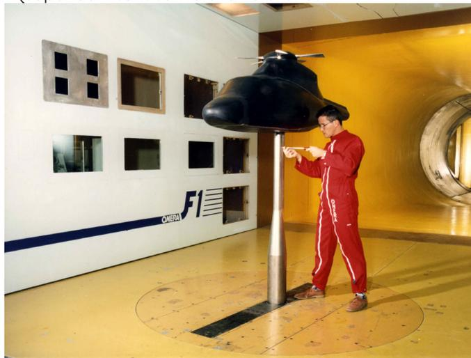
Figure 190 - Maquette DGV 200 dans la soufflerie pressurisée F1 du Fauga
