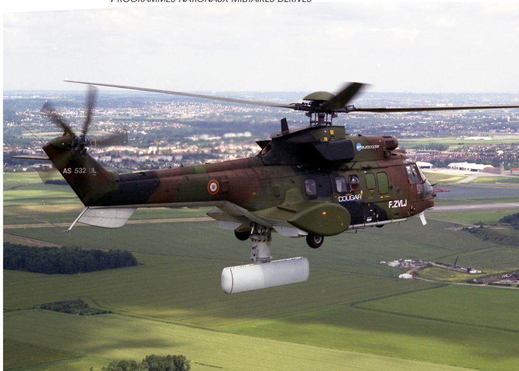
Figure 180 - Hélicoptère HORIZON antenne déployée (photo CEV)
