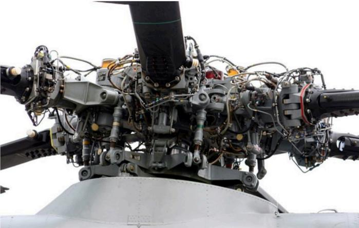
Figure 51 - Le moyeu repliable du SA 321 G
