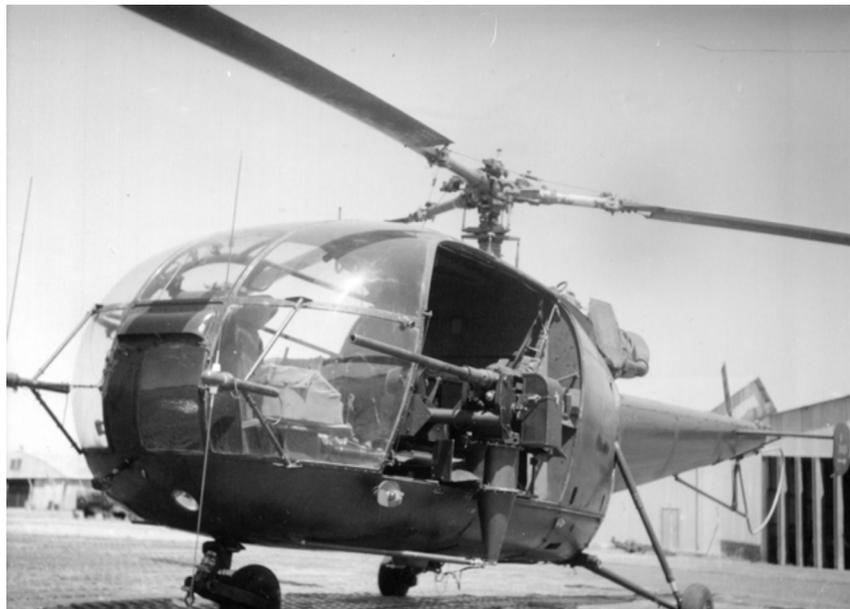
Figure 39 - SE 3160 n° 02, toute première machine livrée à l'ALAT dès 1961, pour expérimentation, équipée ici d'une mitrailleuse en sabord.
