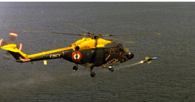
Figure 93 - Tir d'AS 12 du WG 13 05-04
