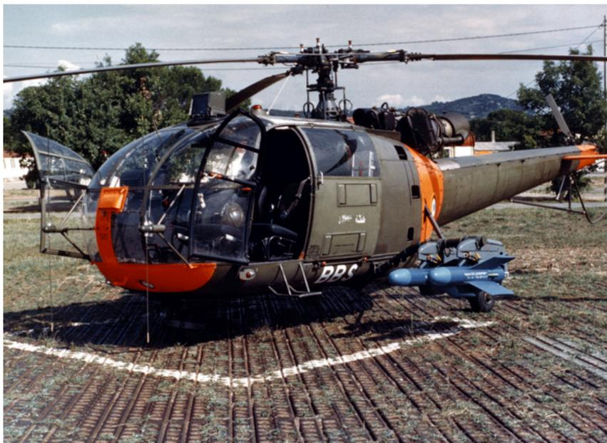
Figure 41 - SA 316 B équipée du « système » AS 12 (maquettage)
