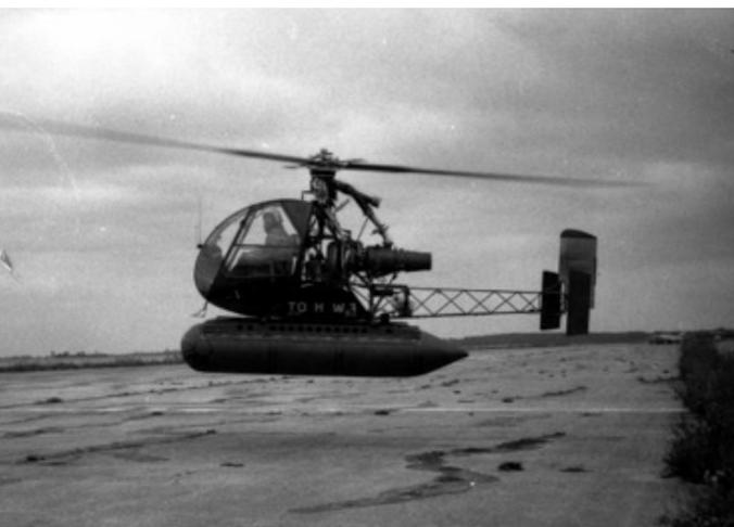
Figure 77 - Djinn avec flottabilité en essai au CEV (photo CEV)
