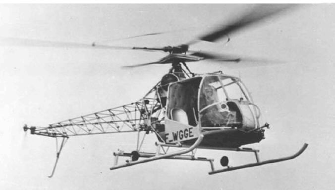
Le SE 3120 « Alouette » volera enfin le 31 juillet 1951, aux mains d'Henri Stackenburg, à Buc. Il est équipé d'un rotor tripale de 11 m 60 et d'un moteur Salmson 9H de 200 ch. Il a établi plusieurs records du monde dont 1 250 km en circuit fermé.
