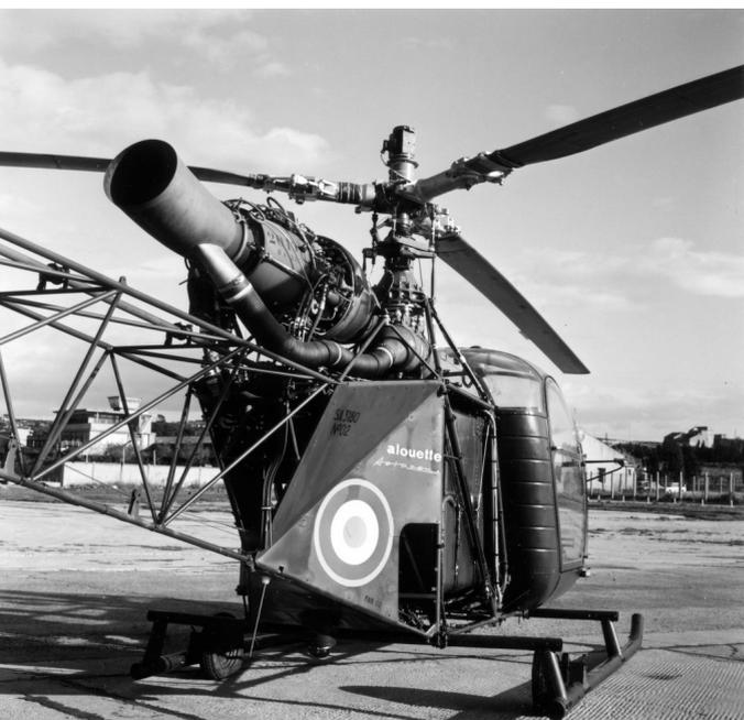
Figure 34 - Alouette II Astazou SA 3180 n°02 équipée à titre expérimental d'un moyeu MIR de Bölkow © Photo DR/Airbus Helicopters
