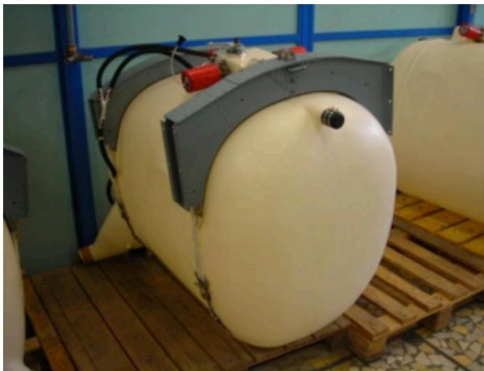
Figure 143 - Réservoir de carburant Écureuil
