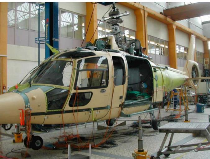
Figure 195 - Essai vibratoire au sol de l'EC 155
