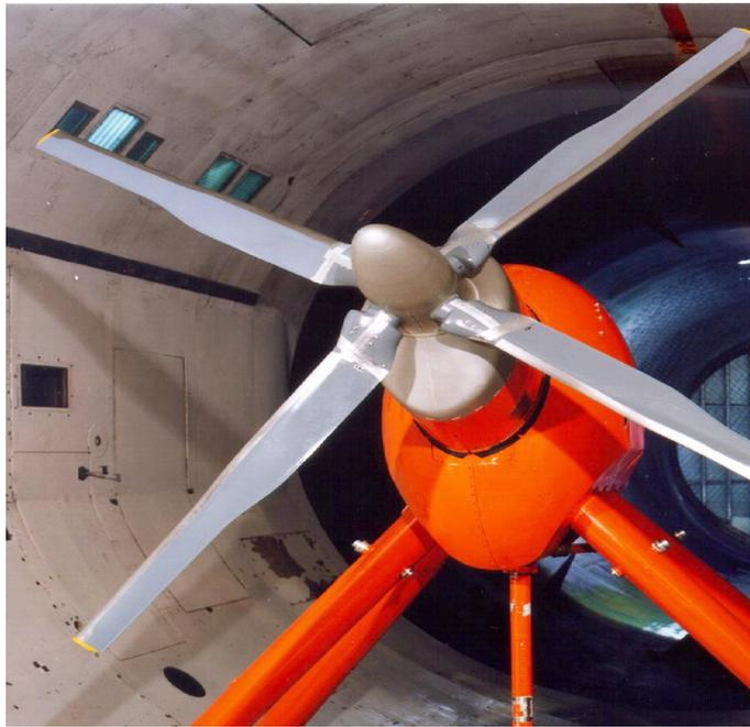
*Figure 198 - Rotor de convertible RC4 dans la soufflerie S1 de Modane*
