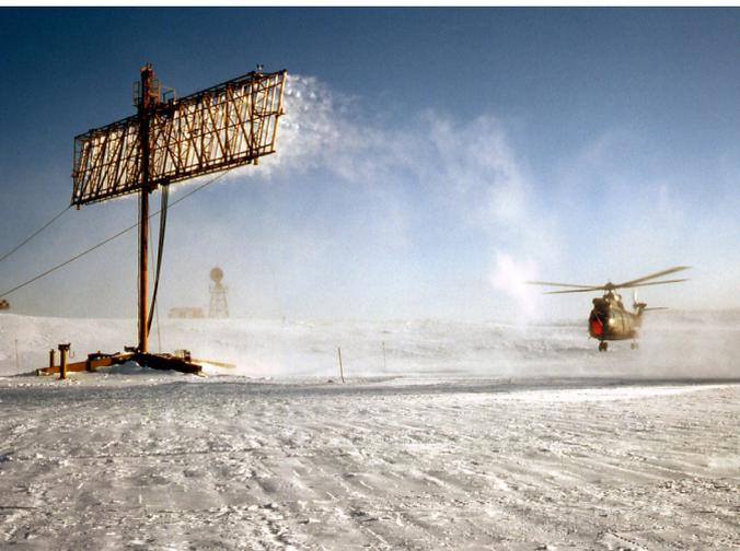
Figure 72 - Essai de givrage devant la grille du NRC à Ottawa
