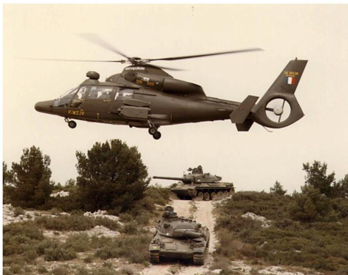
Figure 135 - SA 365M « Panther » n°6005 équipé du TM333 et du système antichar HOT
