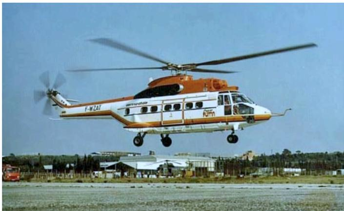
Figure 123 - Le SA 331 au cours de son premier vol. L'appareil a été profondément modifié et le nez rallongé. Remarquer la tête rotor, le train et la poutre de queue. © EC
